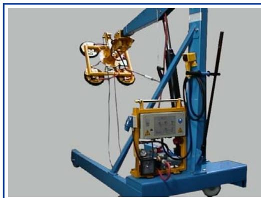
**Монтажный кран со встроенным вакуумным насосом для работы от аккумулятора**
