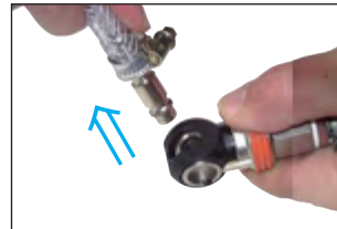
Stecker wird drucklos entnommen.
