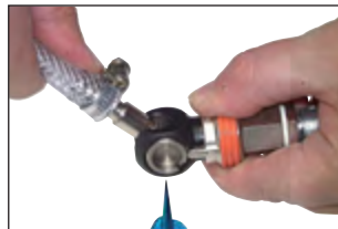
Kupplung ausschwenken - Kupplung schließt und entlüftet
