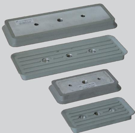
Прямоугольные присоски Тип BLSP Серии BY. Уплотнитель из серого бутадиен-нитрильного каучука (БНК). Твёрдость по Шору ок. 60. Эти присоски часто используются в станках обработки стекла для фиксации заготовок, но так же применимы в других областях. Центральное отверстие под вакуумный коннектор, остальные – крепёжные.
