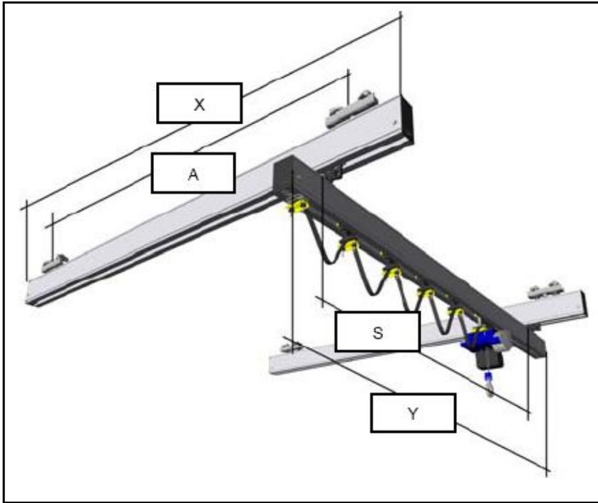
6. Тросовая система для спирального пневмопровода (если п. 12 (ПИТАНИЕ ВАКУУМНОГО ГЕККОНА) - СЖАТЫЙ ВОЗДУХ)
