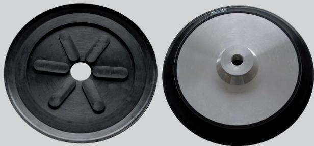
Резиновый уплотнитель Тип BLSP 290 BR на алюминиевой основе. Уплотнитель изготовлен из чёрного бутадиен-нитрильного каучука (БНК), диаметр 290 мм. Твёрдость по Шору ок. 65. Уплотнитель съёмный, крепится зажимом. Основа имеет центральное резьбовое отверстие для крепления присоски.
