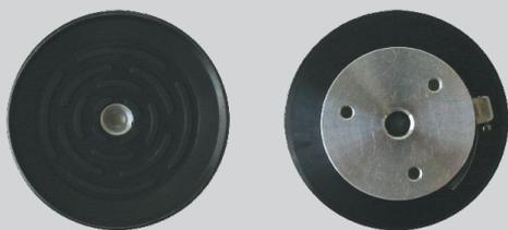
Плоская присоска Тип BSC 80L. Диаметр 80 мм. Уплотнитель сменный, крепится зажимом. Изготовлен из чёрного бутадиен-нитрильного каучука (БНК). Алюминиевая основа имеет центральное резьбовое отверстие 1/8" и три резьбовых отверстия М5.
