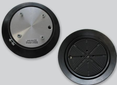
Плоские присоски Тип BLSP 200 PK. Уплотнитель изготовлен из чёрного бутадиен-нитрильного каучука (БНК), диаметр 200 мм. Твёрдость по Шору ок. 50. Уплотнитель съёмный. Крепится зажимом. Основа из алюминия, имеет 4 вывода с резьбой. В большинстве случаев, присоски используются в вакуумных захватах. Отверстия можно адаптировать под требования заказчика.
