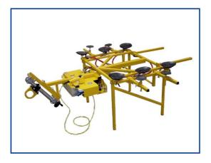
При помощи данных подъемников можно вставлять лобовые стекла легковых, грузовых автомобилей и автобусов. Они являются идеальным решением для ремонта и штучного производства автомобилей, например, бронированных автомобилей.
