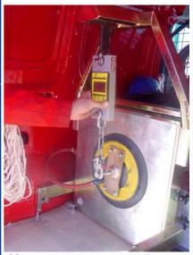
Испытание нагрузкой отдельного присоса
