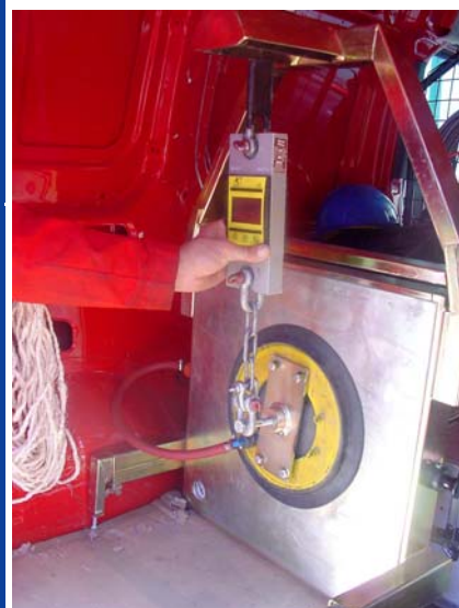
Испытание нагрузкой отдельного присоса
